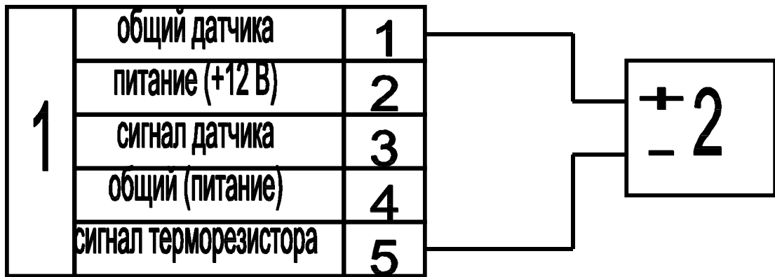
Условные обозначения 1. датчик массового расхода воздуха 2. цифровой омметр Рисунок 2
